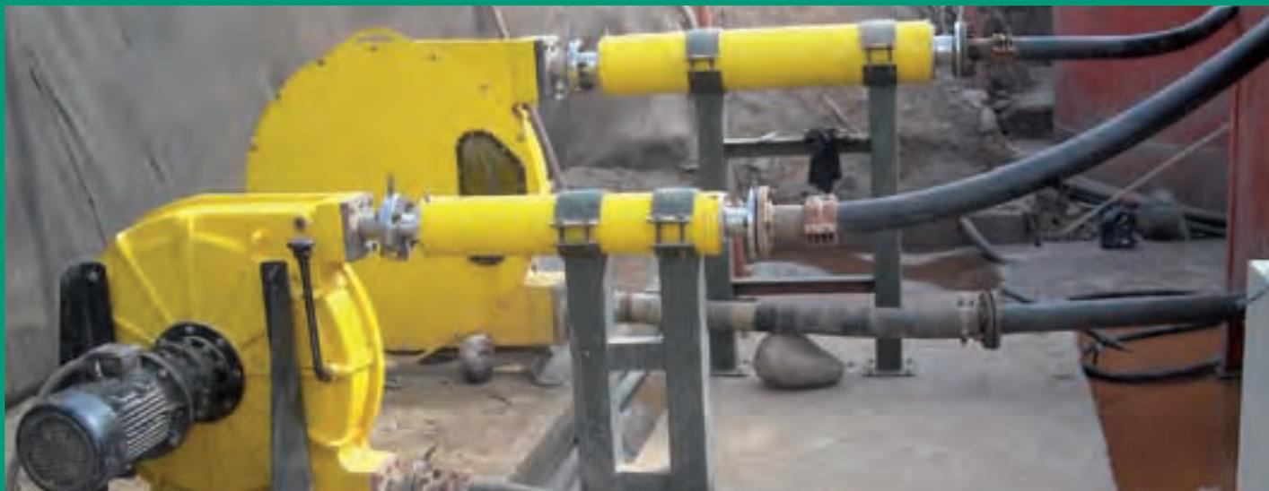
**Удачная конструкция и высокое качество перистальтических насосов Boyser позволяет им работать со шламами и илами с высоким содержанием твердых частиц в концентрации до 80% объема.**
