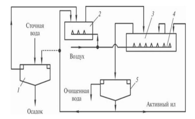
Доступ к кислороду обеспечивают аэраторы – перфорированные трубы. Когда по ним проходит воздух, сточные воды насыщаются кислородом.
