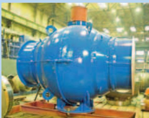
с аттестацией предприятием была разработана и согласована с Газпромом «Инструкция по сварке и контролю качества сварных соединений колец переходных с трубопроводной арматурой», что является одним из основных документов при производстве кранов с переходными кольцами, в том числе на газопровод «Бованенково-Ухта».
