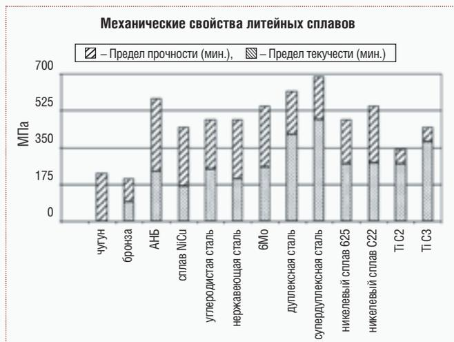
Рис. 1. Прочность отливок
