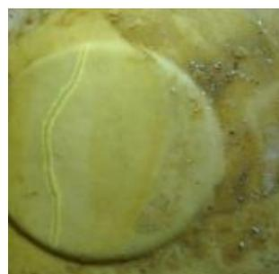
*Расслоения стенки и разлом оболочек в месте стыковки с горловиной. Трещины.*
