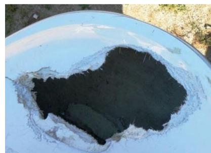
*Сквозные трещины и проломы стенки корпуса.*
