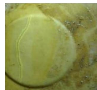
Расслоения стенки и разлом оболочек в месте стыковки с горловиной. Трещины.
