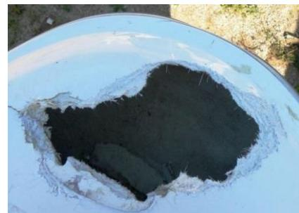
Сквозные трещины и проломы стенки корпуса.
